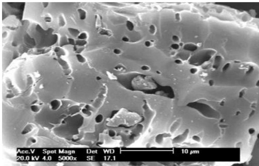
**Figura 5:** Microscopia eletrônica de varredura para CAED após ativação (5000x).
