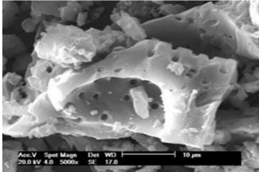
**Figura 4:** Microscopia eletrônica de varredura para CAED antes da ativação (5000 x).
