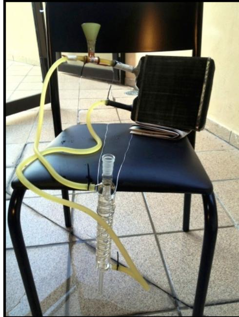
Figura 2 - Condensador
