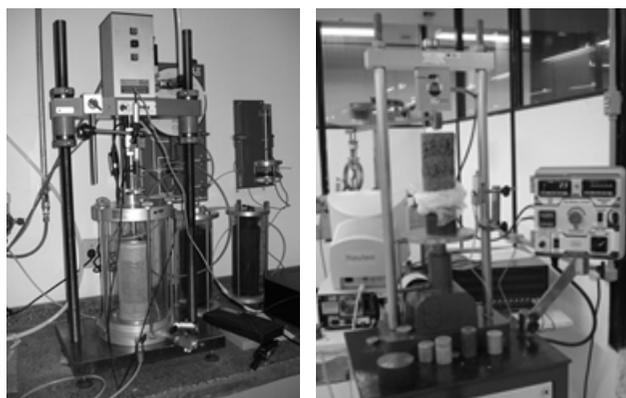
Figura 2.11. Equipamentos: a) Prensa triaxial cíclica b) Prensa para compressão simples
