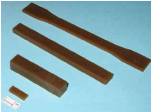
Figura 21. Corpos de prova provenientes do molde instalado na injetora: 1 - Tração; 2 - Impacto; 3 - Flexão e 4 - Cisalhamento
