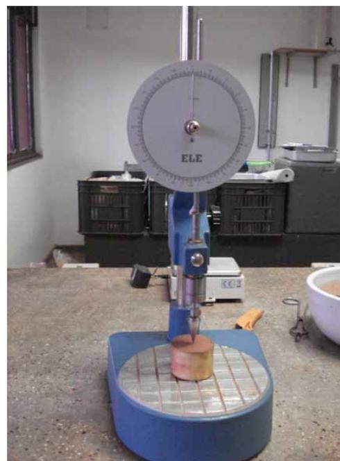
Figura 2.6. Cone de penetração para o ensaio de limite de liquidez
