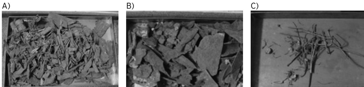
Figura 2.4. Triagem de materiais contaminantes: a) Madeira b) Plásticos c) Ferro
