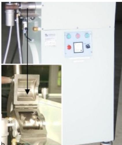
Figura 18. Homogenizador de plásticos de laboratório (misturador termocinético), e no detalhe, cápsula do compartimento de mistura.
