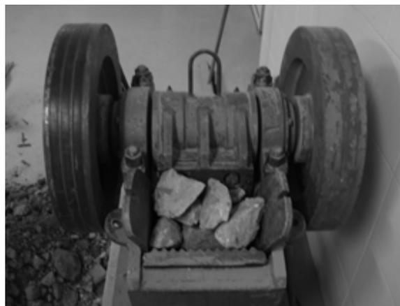
Figura 2.3. Britador de mandíbulas utilizado na britagem secundária. Laboratório de Geocronologia
