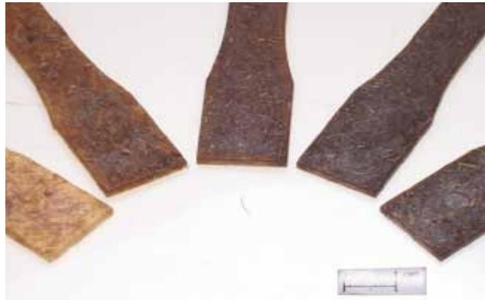
Figura 22. Compósitos de polietileno reforçados com bagaço - 5%, 10%, 15%, 20% e 25% (m/m) - de fibras (esquerda para a direita), obtidos por meio da extrusora
