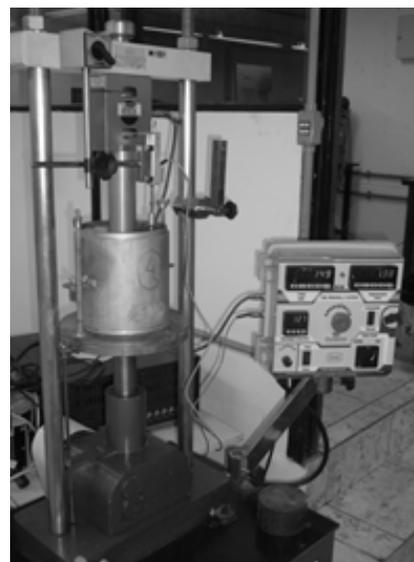
Figura 2.10. Equipamento usado na penetração do ensaio CBR sobre RCD
