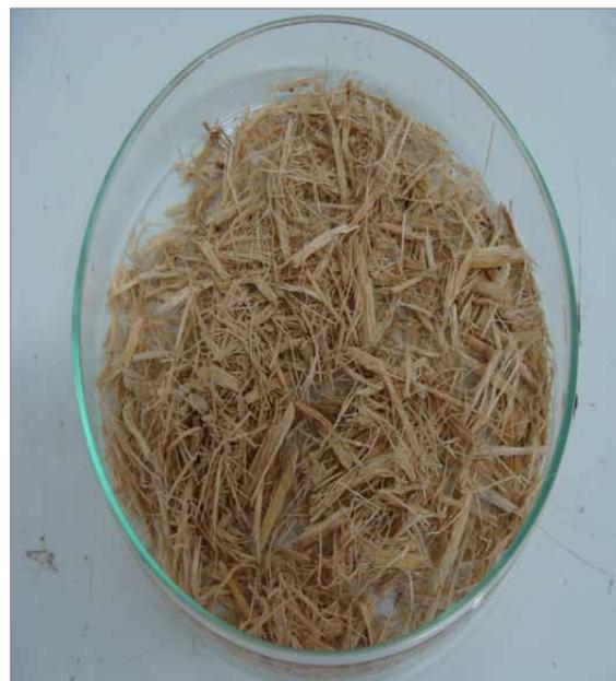
Figura 4. Bagaço de cana-de-açúcar utilizado na obtenção dos compósitos
