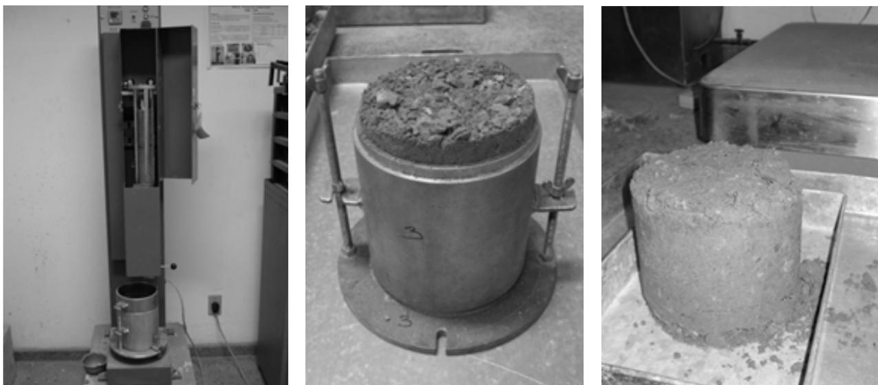
Figura 2.9. Compactador mecânico e corpo de prova de RCD após compactação Proctor
