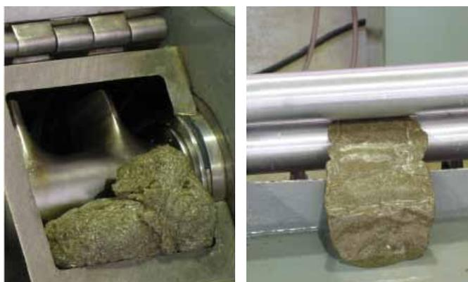
Figura 19. Esquema de preparação dos compósitos BNT, utilizando o misturador termocinético.
