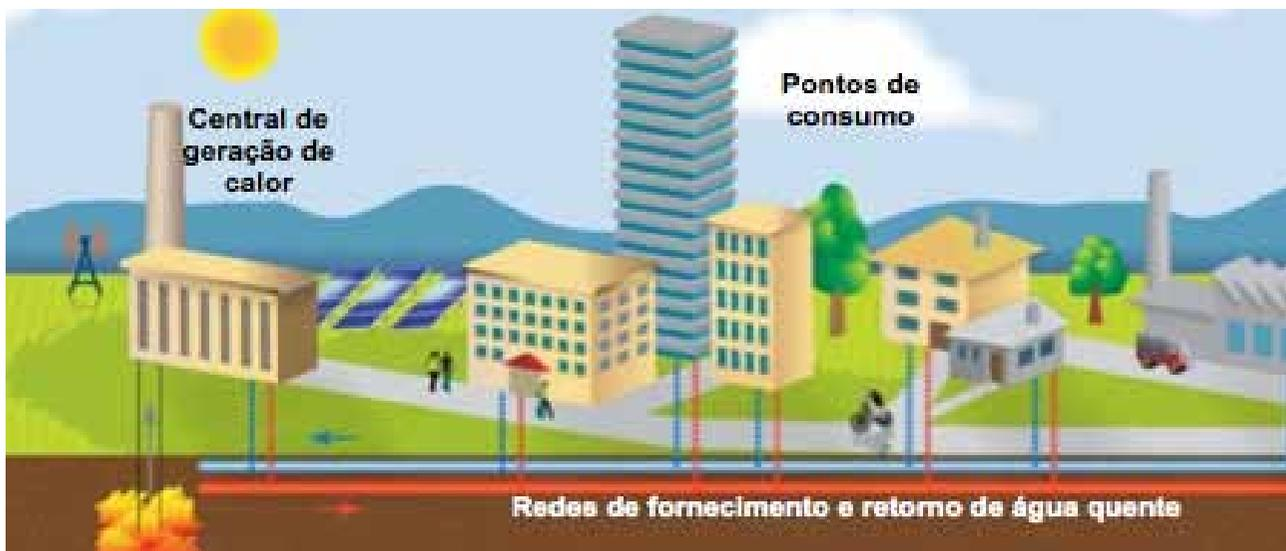
Figura 12: Esquema de sistema de aquecimento distrital. Fonte: DHC Technology Platform (2009)
