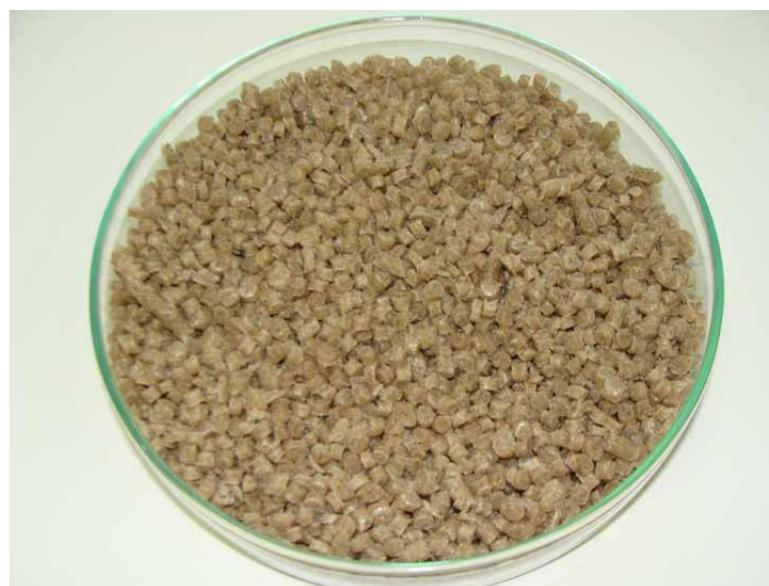
Figura 17 - Grânulos dos compósitos obtidos após extrusão
