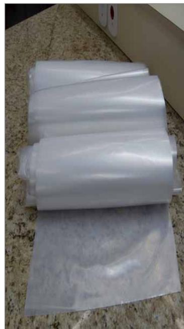
Figura 3. Filmes plásticos utilizados na obtenção dos compósitos
