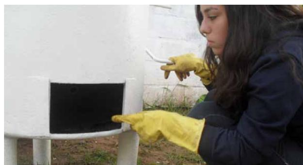
Figura 9: Indicação do orifício de saída do composto maduro após 90 dias
