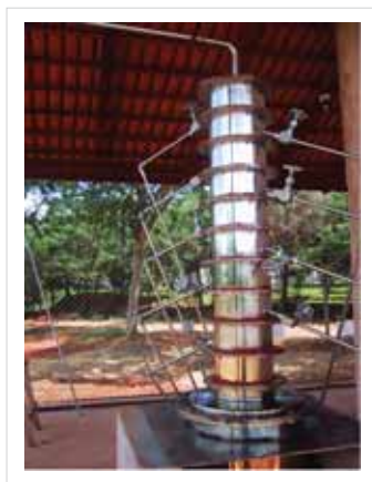
Figura 8 - Protótipo de usina de craqueamento inaugurado em dezembro de 2002 para produzir 200 L dia-1 de diesel a partir de óleos vegetais.
