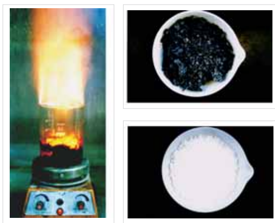
Figura 3. (a) Proceso de combustión para la síntesis de polvos de ZrO_2-Y_2O_3 empleando ácido cítrico como combustible. (b) Cenizas obtenidas luego de la combustión. (c) Polvo nanocristalino obtenido luego de una calcinación a 600^\circ C durante 2 hs.
