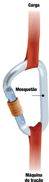
Outro exemplo é o dos mosquetões de montanhismo. O produto, utilizado em escaladas, é fabricado com uma liga de alumínio de alta resistência mecânica, boa resistência à corrosão e boa moldagem. Para avaliar a carga suportada pelo produto, aplica-se o ensaio de tração até o rompimento e só depois se definem os padrões de segurança e limites de vida útil.
