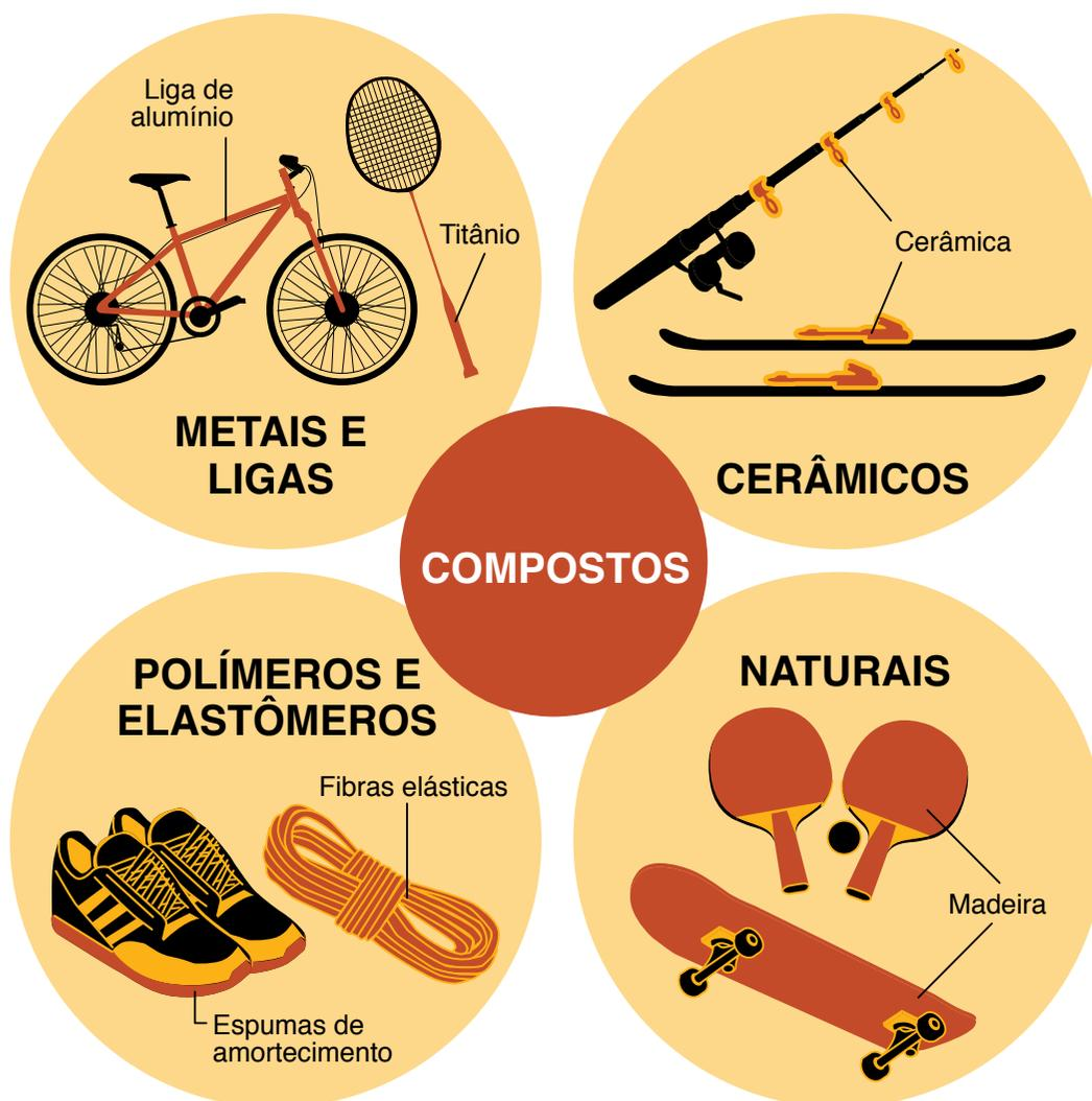
Frequentemente, os equipamentos esportivos combinam peças de materiais diferentes e compostos na forma de ligas metálicas, cerâmicas, polímeros e outros
