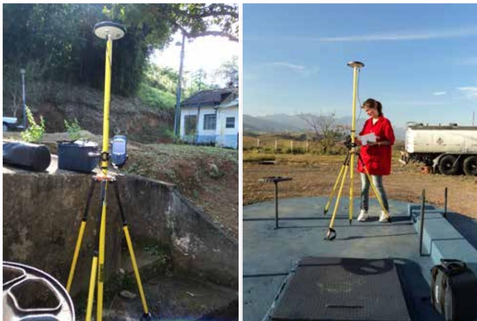
Figura 11. Instalação do DGPS de base e móvel.
