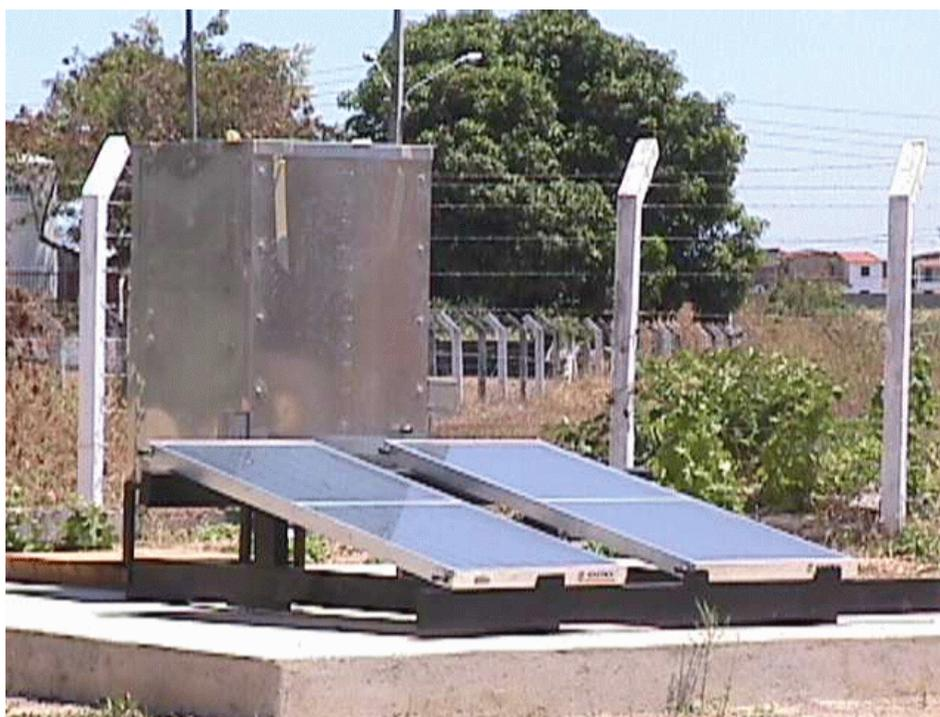
Figura 3. Dessalinizador térmico com sistema de recuperação de calor. Fonte: Lima (2000).
