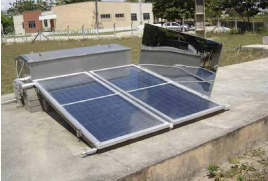
Figura 5. Dessalinizador com sistema de recuperação de calor com tubo de distribuição de água no tanque de armazenamento. Fonte: Alves (2009).
