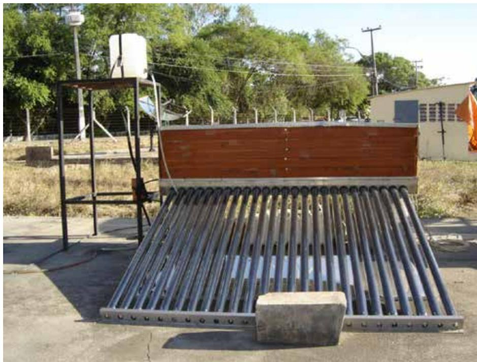
Figura 6. Dessalinizador aquecido por coletores de tubos evacuados com perfis e canais de poliuretano.
