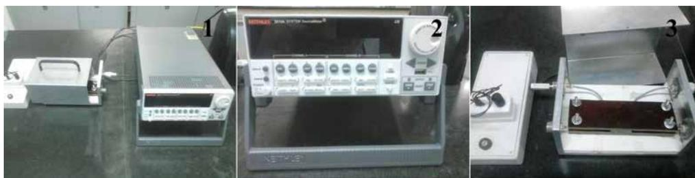
Figura 4 – Sistema montado para a medição (1), fonte Keythley (2), sistema de eletrodos isolados ligados ao tipo dois fios (3)
