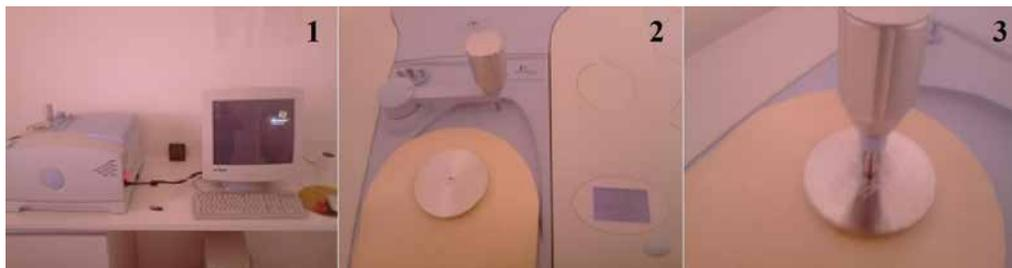
Figura 2 – Aparelho utilizado para a análise FTIR (1), base e cristal do espectrofotômetro (2), amostra sendo pressionada contra o Cristal pela punção para análise (3)
