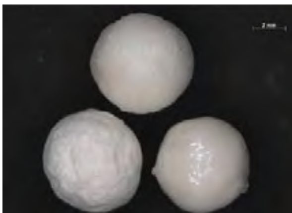
Figura 5. Grãos de corderita: à esquerda, puro; no meio, impregnado com PEG; à direita, impregnado com PEG e revestido com poliuretano.
