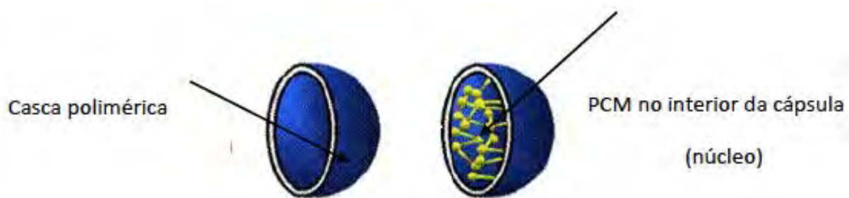
Figura 4. Microcápsulas com morfologia tipo núcleo-casca. Material térmico dissolvido no núcleo.
