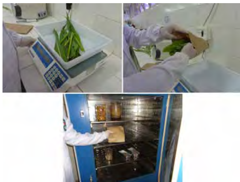
Figura 9. Procedimento do material, pesagem, acondicionamento em sacos de papel e estufa de circulação de ar forçado. Mossoró/RN. 2010. Fonte: Dados do acervo de pesquisa.
