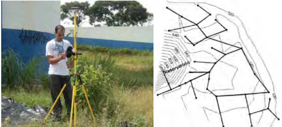
Figura 13. Levantamento topográfico da rede Vista Alegre.
