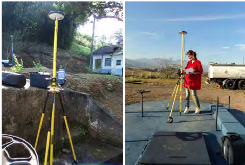
Figura 11. Instalação do DGPS de base e móvel.
